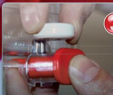
**3** Das Klicken des magnetischen Verschlussbolzens hat zur Folge, dass die Sicherungsriegel nun herausgezogen werden können.
